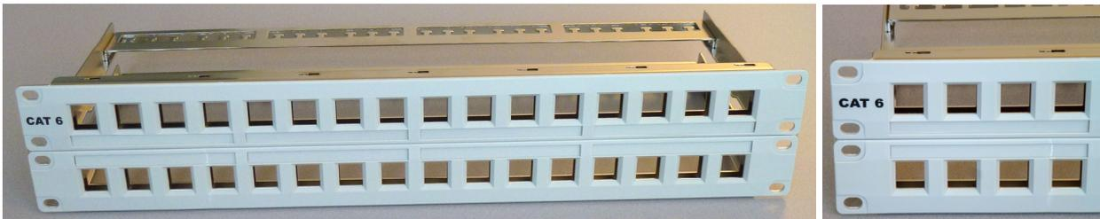
Die Verteilerfeldrahmen sind für den Einbau in 19" Lochrasterschienen konstruiert und bieten in den Ausführungen mit ein und zwei Höheneinheiten Platz für bis zu 16 bzw. 32 Stück Modular Keystone Jacks. Neben der Anschlussmöglichkeit für den Potentialausgleich verfügt der Verteilerfeldrahmen über rückseitig aufsteckbares Kabelmanagement zur Zugentlastung der Daten- und Telekommunikationsleitungen. Im Lieferumfang enthalten:
