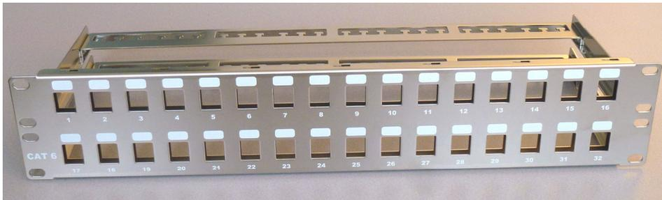
Die Verteilerfeldrahmen sind für den Einbau in 19" Lochrasterschienen konstruiert und bieten in den Ausführungen mit ein und zwei Höheneinheiten Platz für bis zu 16 bzw. 32 Stück Modular Keystone Jacks. Neben der Anschlussmöglichkeit für den Potentialausgleich verfügt der Verteilerfeldrahmen über rückseitig aufsteckbares Kabelmanagement zur Zugentlastung der Daten- und Telekommunikationsleitungen. Im Lieferumfang enthalten
