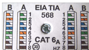
Beschaltung bei Ausführung mit horizontaler Kabelzuführung
